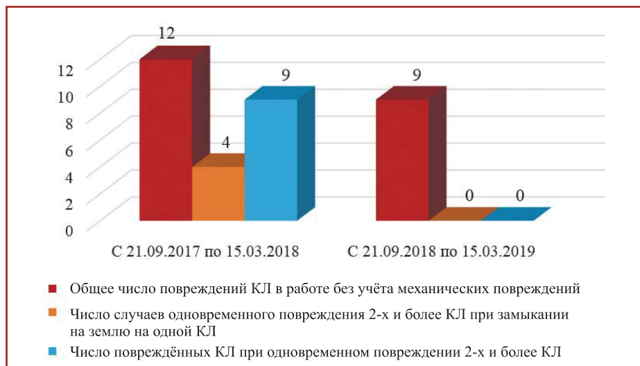
Рис. 7. Статистика повреждений КЛ
