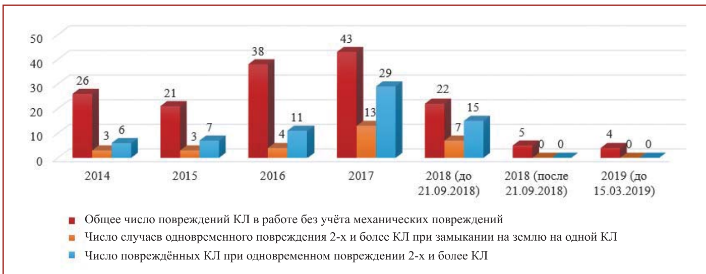
Рис. 8. Статистика повреждаемости КЛ сети, запитанной от ПС «Дёма», с 2014 г. по 15.03.2019 г.
