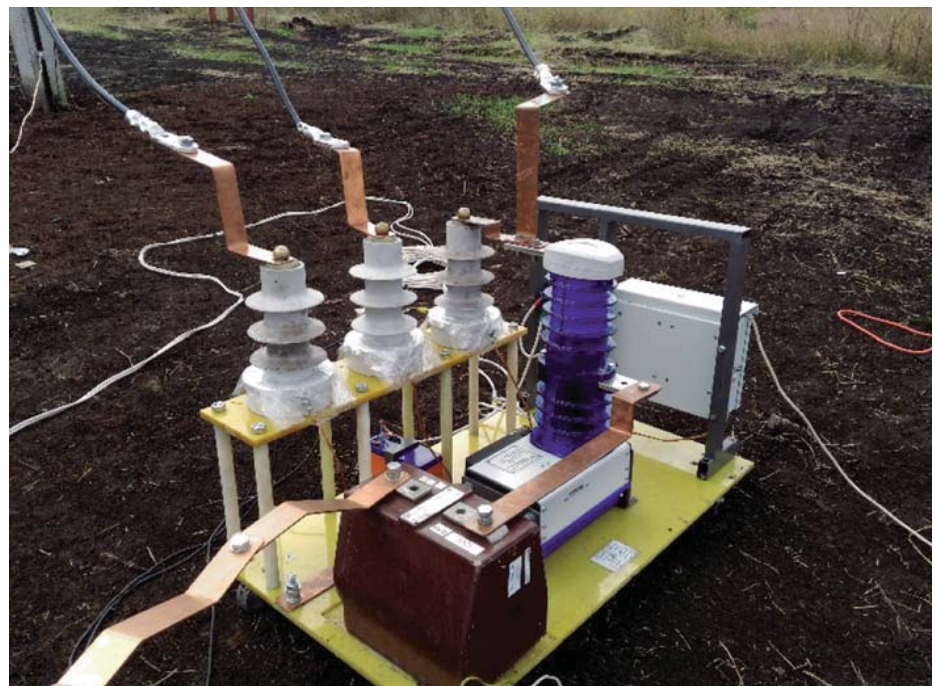
Рис. 5. Внешний вид устройства для организации и контроля параметров искусственного ОЗЗ с однополюсным вакуумным выключателем
