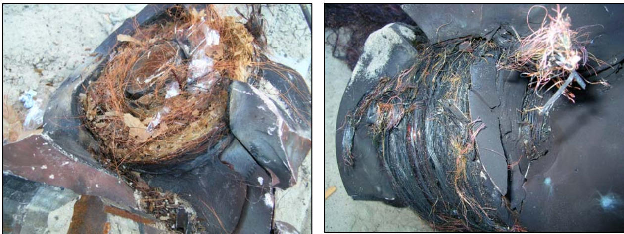
Рис. 3. Первичные обмотки поврежденных ТН-35 кВ с литой изоляцией с выраженным расслоением межвитковой изоляции (а) и перегоранием медных проводников обмотки ВН (б)
