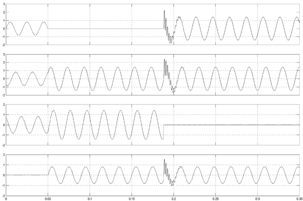
Рис. 8. Осциллограммы напряжений в фазах А, В, С и в нейтрали (сверху вниз соответственно) рассматриваемого примера с ДГР.
