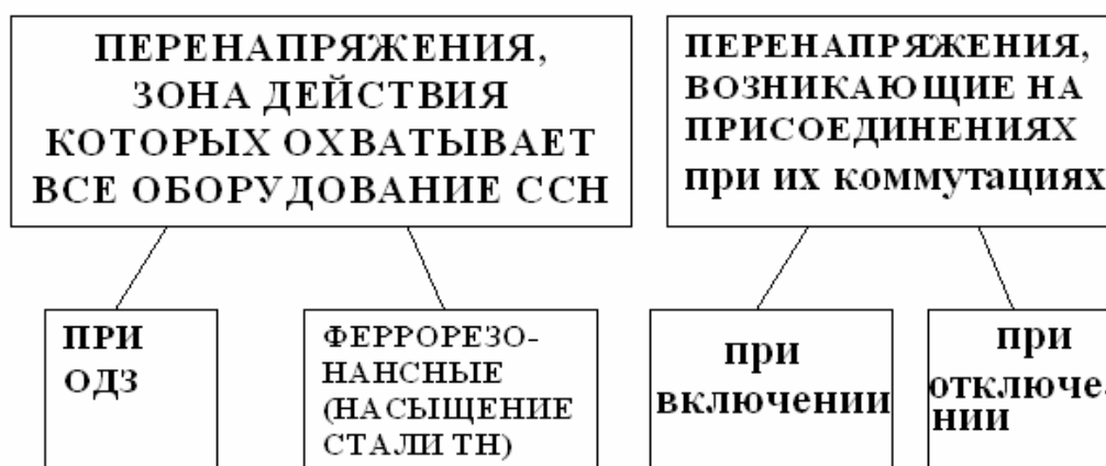
Рис.1. Классификация внутренних перенапряжений перенапряжений в сетях 6-35 кВ
